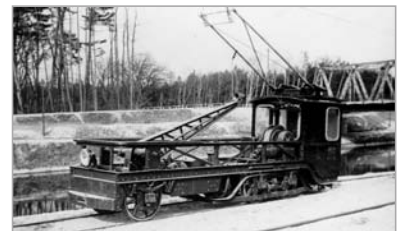
Ab 1935 eingesetzte dreiachsige Treidellokomotive der Firma Siemens-Schuckert. Die Schleppgeschwindigkeit betrug 5,5 km/h. Antrieb 2 x 19 PS. Links erkennbar der bewegliche Treidelmast.
